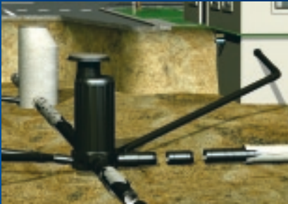
Freigefälleleitungen Gravity Pipes
