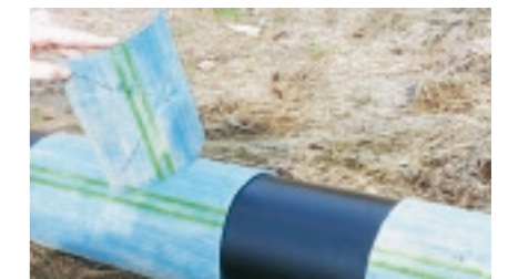
Die Rohroberfläche ist glatt und sauber The pipe surface is smooth and clean
